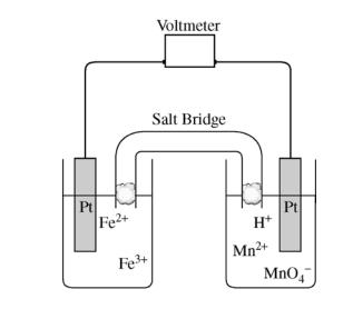
$5 \text{ Fe}^{2+}(aq) + \text{MnO}_4^{-}(aq) + 8 \text{ H}^+(aq) \rightarrow 5 \text{ Fe}^{3+}(aq) + \text{Mn}^{2+}(aq) + 4 \text{ H}_2\text{O}(l)$
